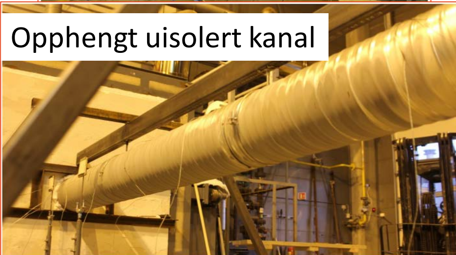
Figur 4-10 Kanalen på bildet hadde 2,4 m avstand mellom hvert opphengspunkt, og det var ingen tegn til deformasjon eller skader på kanalen etter test. Bildet er fra test R5.
