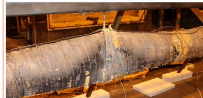
Figur 4-17 Kanalen har blitt kraftig deformert i opphengspunktene. Bildene er fra test R4.
