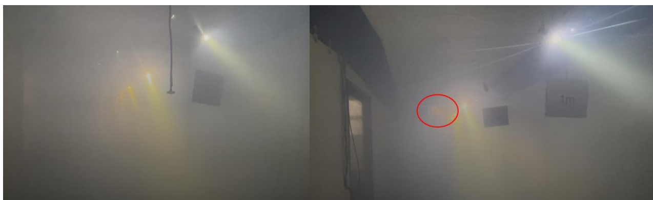
Figur 5.16: Steng inne-løsning til venstre og trekk ut-løsning til høyre etter 7 minutter og 40 sekunder. Rømningsskiltet er markert i den røde sirkelen på bilde til høyre.
