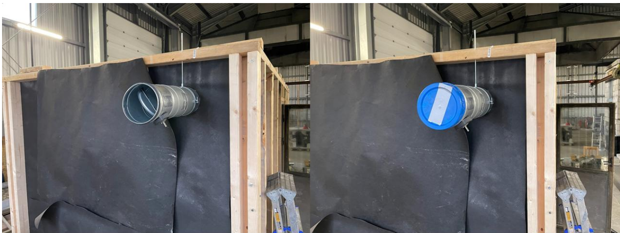
Figur 3.3: Bilde av tilluftsventil. Trekk ut-løsning til venstre, og steng inne-løsning til høyre.
