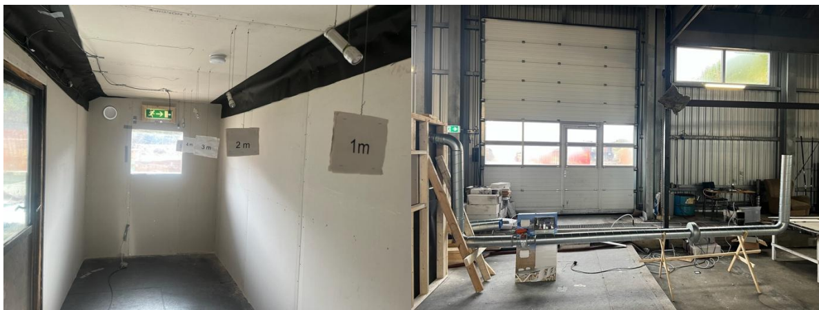
Figur 3.2: Innsiden av testrommet og montering av ventilasjonsanlegget
